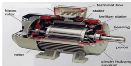
Gambar 3. Konstruksi Motor Listrik 3 Fasa
