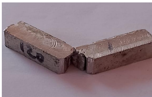
Gambar 3. Penampang Patah Aluminium 6061 setelah di Uji Impact (Pengelasan dengan variasi arus 120 A).
