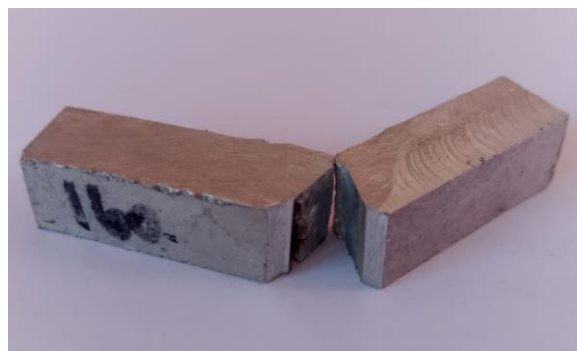
Gambar 5. Penampang Patah Alumunium 6061 setelah di Uji Impak (Pengelasan dengan variasi arus 160 A).
