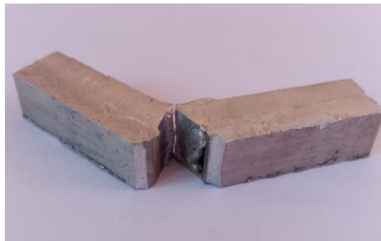
Gambar 4. Penampang Patah Alumunium 6061 setelah di Uji Impak (Pengelasan Dengan Variasi Arus 140 A).
