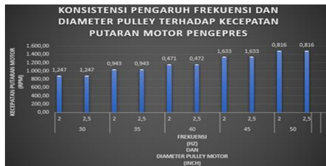
Gambar 11. Konsistensi Pengaruh Frekuensi Dan Diameter Pulley Motor Terhadap Kecepatan Putaran Motor Pengepres.
