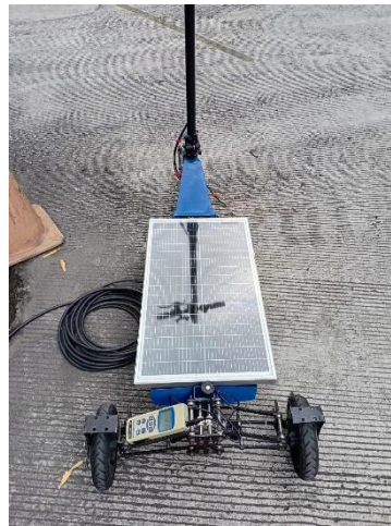
Gambar 1. Pengujian Panel surya pada scooter.
