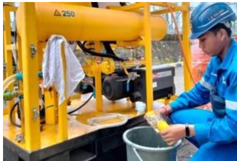
Gambar 2. Alat Filterisasi Minyak (Sumber: Dokumentasi Pribadi)
