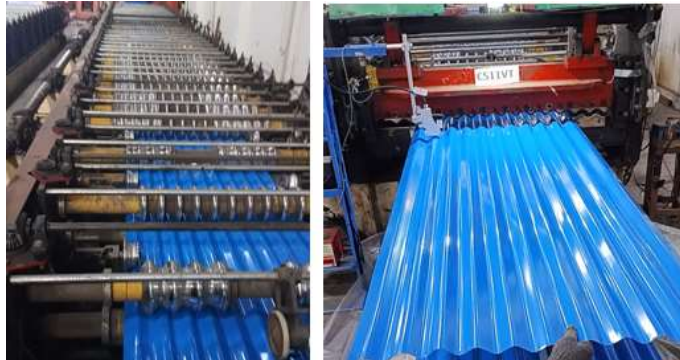
Gambar 5. Produksi Atap Galvalum Gelombang Sinusoidal Proses Roll Forming .
