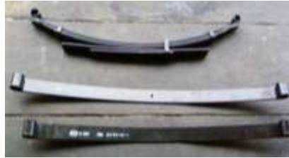
Gambar 2. Contoh Bahan Pisau Rotor Traktor Manual Baja SUP9A dari Pegas Daun (Anonim, 2026).
