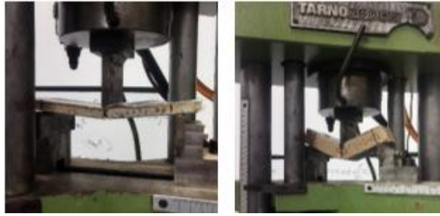
Gambar 2. Proses Pengujian Lengkung.
