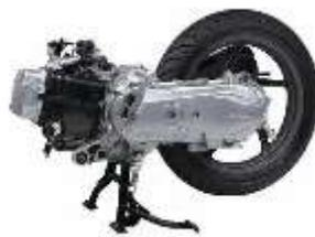
Gambar 1. Konstruksi Mesin Sepeda Motor 4 Langkah
