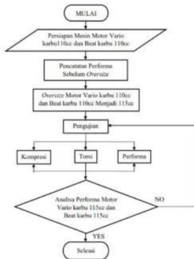
Gambar 2. Flowchart Proses Oversize Mesin Sepeda Motor Tipe Vario Karbu 110cc dan Beat Karbu 110cc.
