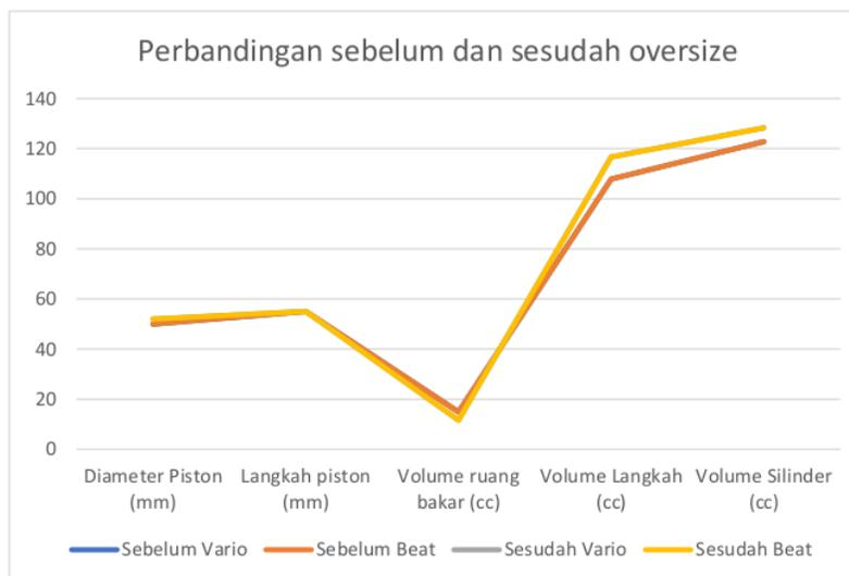
Gambar 4. Perbandingan diamer dan langkah piston
