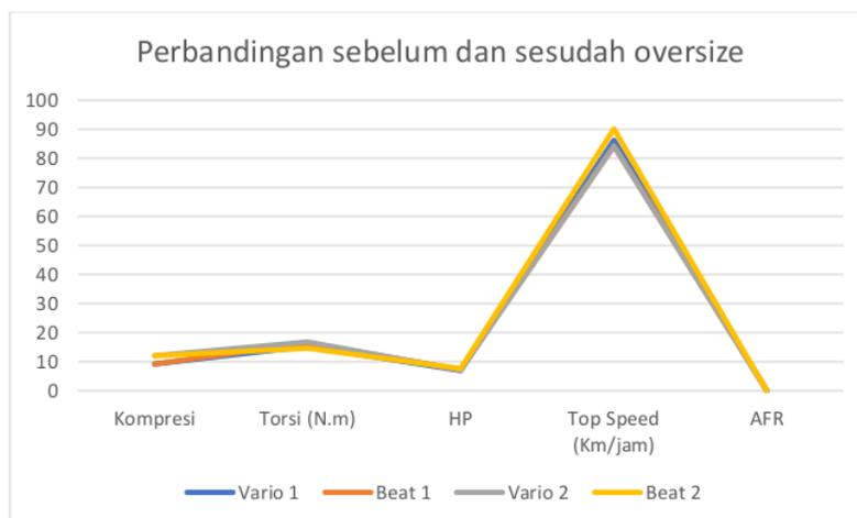
Gambar 5. Perbandingan kinerja mesin
