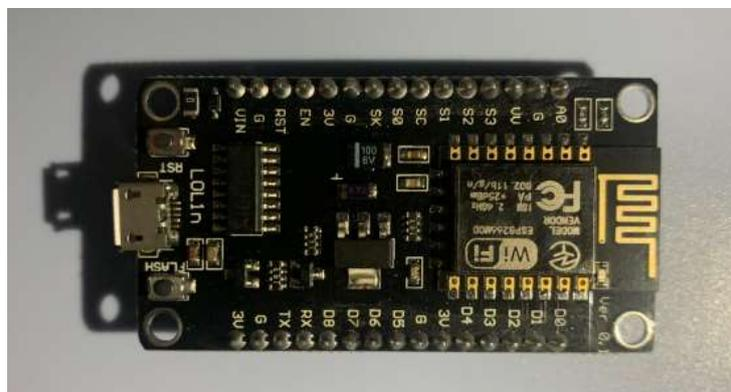
*Gambar 2. NodeMCU ESP8266*
