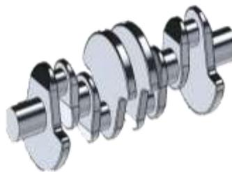
**Gambar 3. Desain poros engkol pada software Solidworks**
