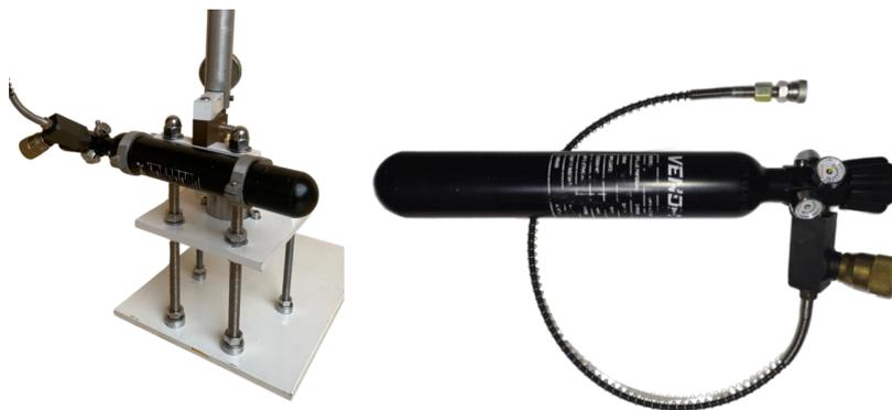
**Gambar 4.2 Tabung PCP 360 cc dan Penempatan Tabung**
