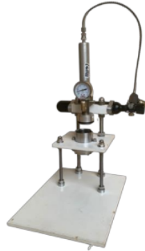
Gambar 4.5 proses perakitan komponen mesin espresso sistem PCP
