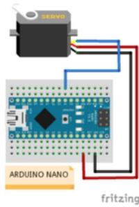
**Gambar 4.4** Skema Rangkaian Pengujian Motor Servo
