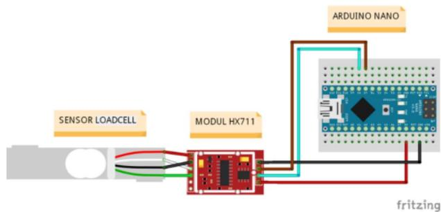
**Gambar 4. 2** Skema Rangkaian *Fritzing* Sensor *LoadCell*
