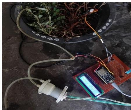
Gambar 12: Hasil Rancangan Prototype Alat Penyiraman
