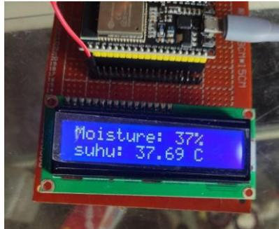
Gambar 13: Pengujian Tampilan LCD Diplay dan Senor DHT 11
