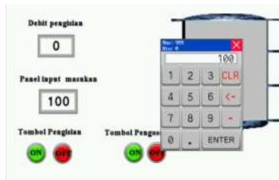
Gambar 11. Tampilan proses pengaturan volume pada panel input masukan
