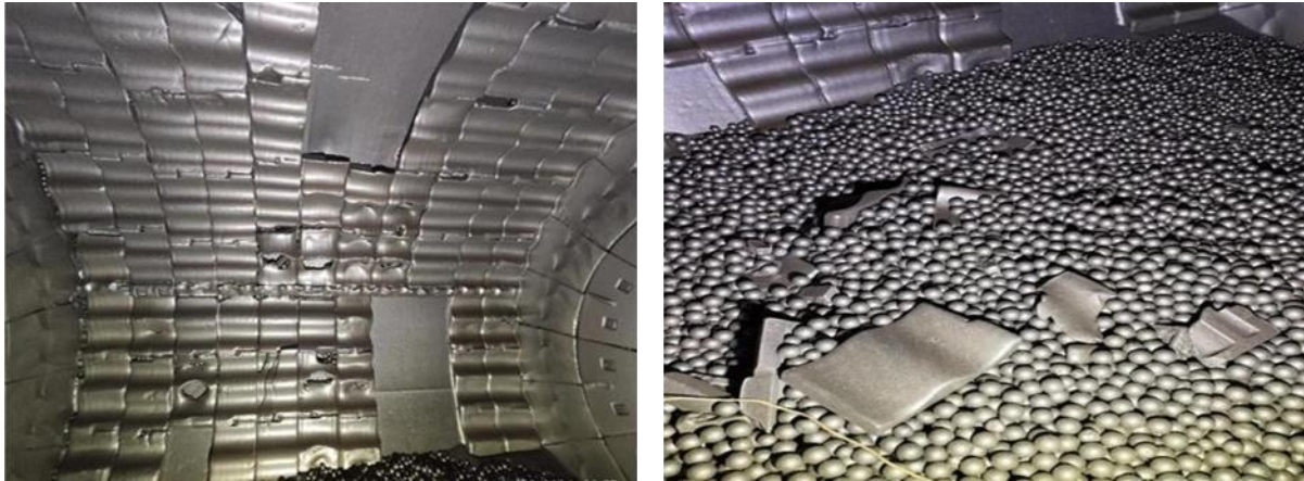
Gambar 3. Fotolining plat ballmill yang lepas dan rusak
