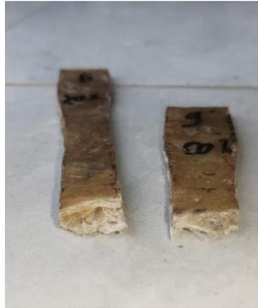
Gambar 2. Patahan Pada Spesimen Uji Tarik No 9
