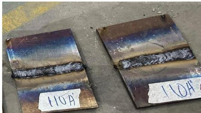
**Gambar 4. Hasil pengelasan pada arus 110 A pada pelat 10 mm, E 11018-G**
