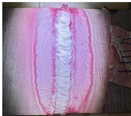
**Gambar 7. Hasil NDT pada arus 110 A pada pelat 10 mm, E 11018-G.**
