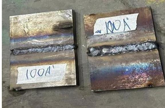
**Gambar 3. Hasil pengelasan pada arus 100 A pada pelat 10 mm, E 11018-G**
