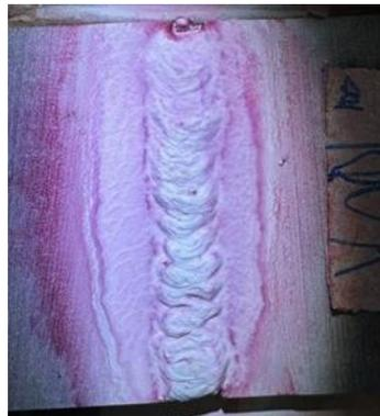
**Gambar 6. Hasil NDT pada arus 100 A pada pelat 10 mm, E 11018-G**
