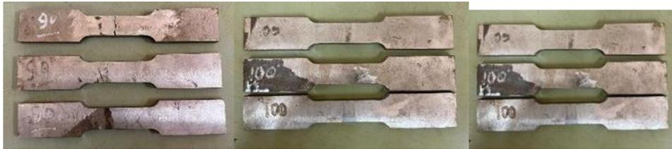
**Gambar 8. Spesimen Sebelum Di Uji.**
