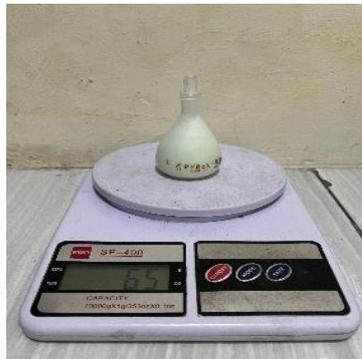
**Gambar 1. Pengukuran densitas**
