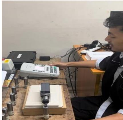
**Gambar 7. Pengukuran kekasaran permukaan baja ST 60**
