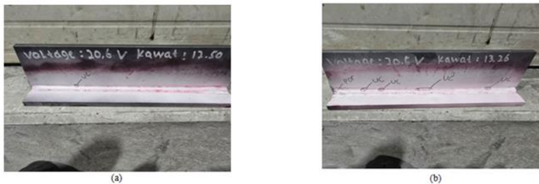
Gambar 6 Hasil penetrant test dengan menggunakan variasi voltage 20.6 V
