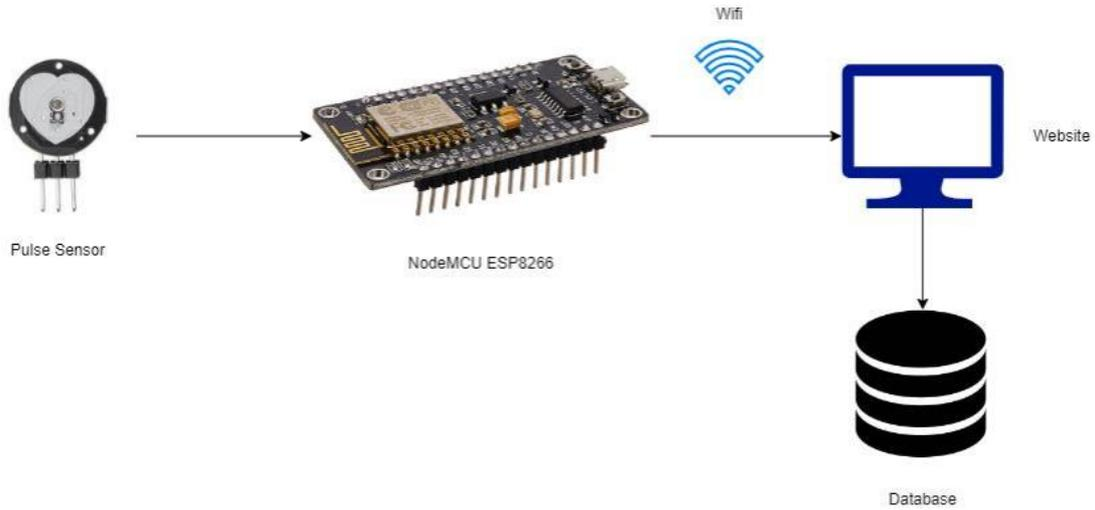
Gambar 3. Perancangan Perangkat Keras (Hardware)
