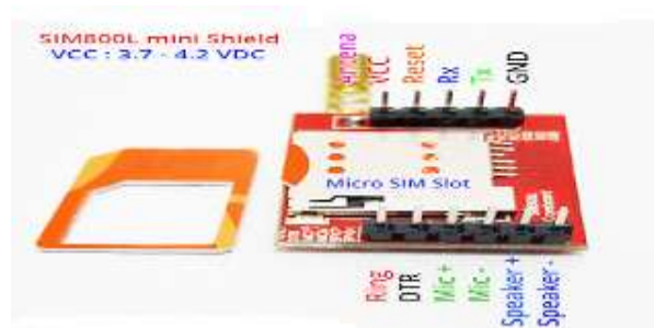
Gambar 5. Modul SIM 800 setelah di solder pin hubung.
