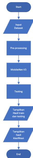
**Gambar 4. Flowchart Model Perancangan**
