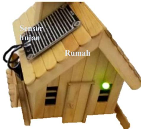
Gambar 7. Pengujian Alat Detektor Hujan
