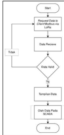
**Gambar 4. Flowchart proses pengiriman Modbus menuju SCADA.**
