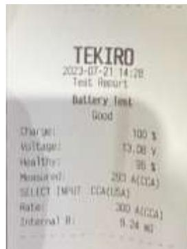
**Gambar 4. 11** Hasil pengukuran dengan *Battery Tester*
