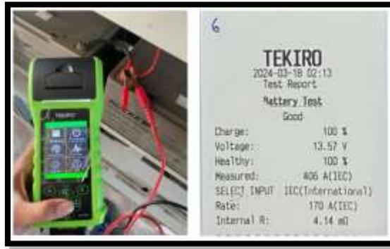
Gambar 4. 6 Hasil pengukuran dengan *Battery Tester* Baterai ES 80-12
