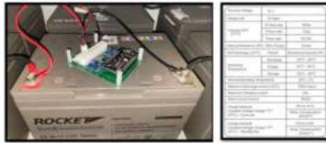
Gambar 4.3 Baterai dan Spesifikasi Baterai ES 80-12
