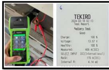
Gambar 4. 6 Hasil pengukuran dengan Battery Tester Baterai ES 80-12
