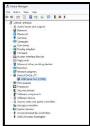
Gambar 4. 2 ESP8266 terbaca di USB Port (COM3)
