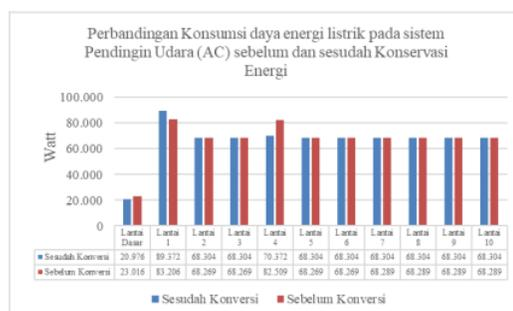
**Gambar 7.** Perbandingan Konsumsi Daya Listrik Sistem Pendingin Udara (AC) Sebelum dan Sesudah Rekomendasi Konservasi Energi
