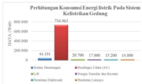
**Gambar 3.** Grafik Perhitungan Konsumsi Energi listrik Pada Sistem Kelistrikan Gedung
