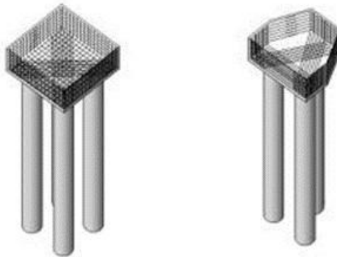
Gambar 18 Pondasi Tiang Pancang
